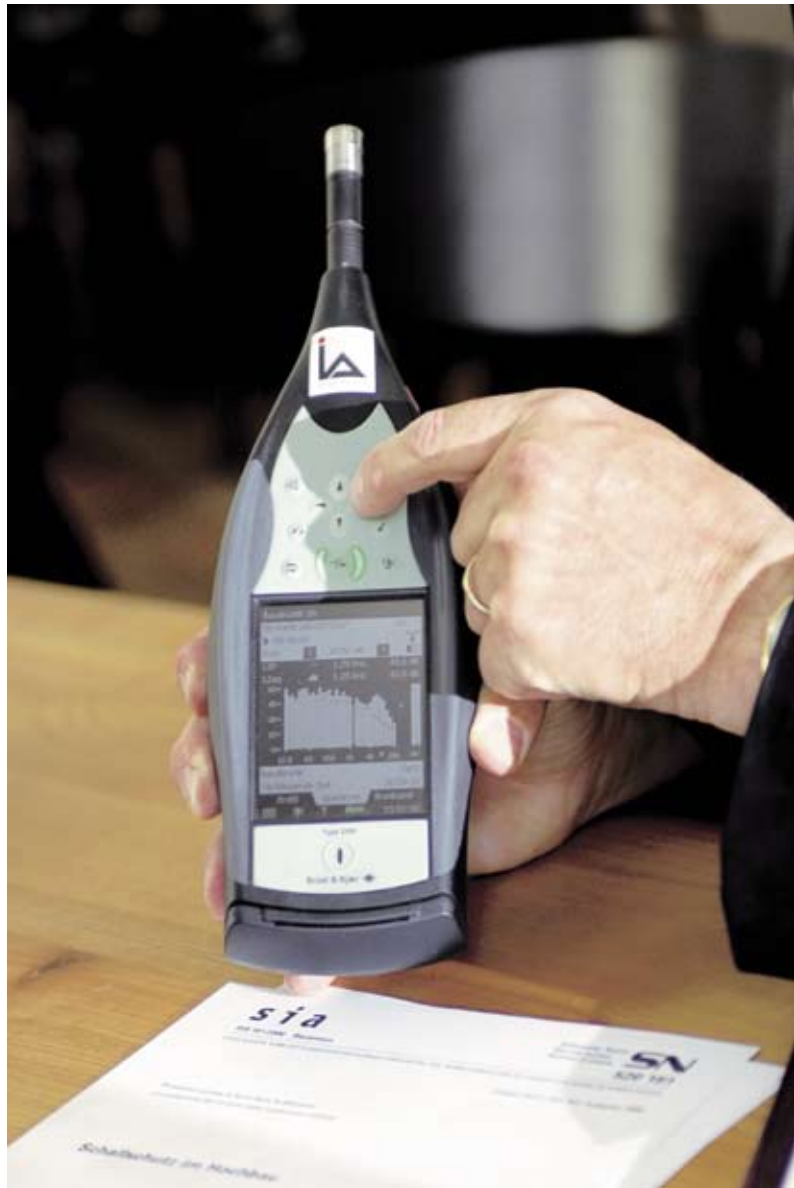
Der Schallanalysator misst die Lautstärke bei verschiedenen Frequenzen im Raum.
